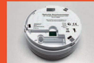
Rauchwarnmelder können sowohl über Netzstrom als auch mit Batterie betrieben werden. Bei allen Betriebsarten sollte jedenfalls das vom Hersteller empfohlene Datum für den Austausch der Geräte beachtet werden, da die Zuverlässigkeit durch Verschmutzung des optischen oder photoelektrischen Systems sowie durch Alterung der Bauteile nach etwa zehn Jahren sinkt.
