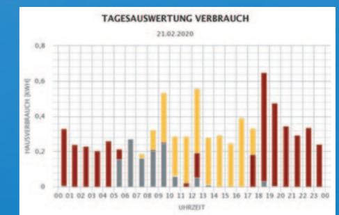
Abb. 3 Stromverbrauch abgedeckt durch die Batterie (rot), durch PV direkt (gelb) oder durch das Kraftwerk (grau)
