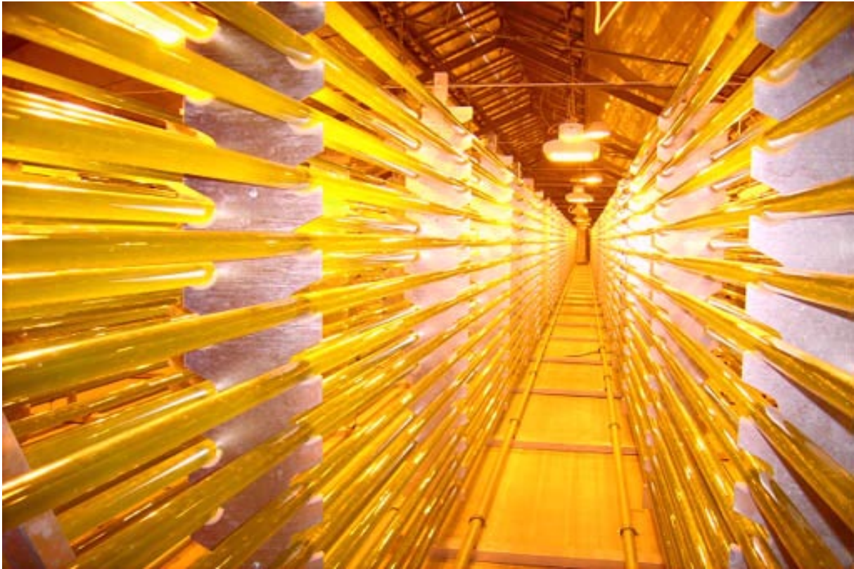
Abbildung: Glasröhren mit Algenkulturen in einer Produktionshalle.
