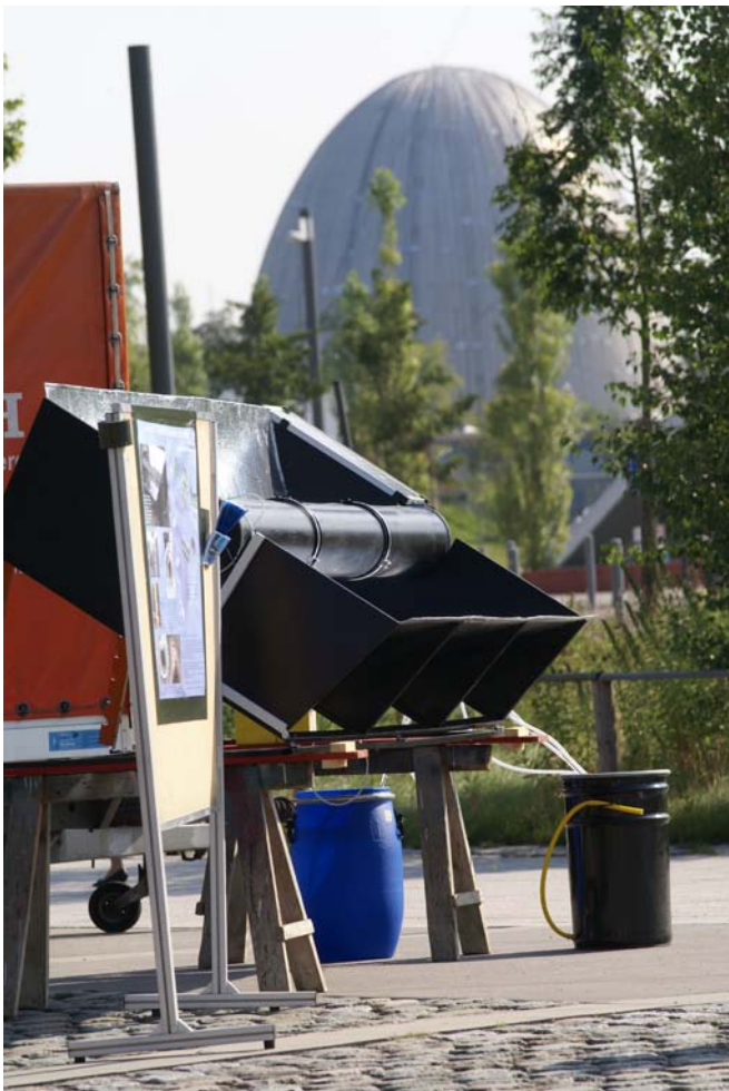
Siegeranlage "Konzentrix" - Parabolrinne mit integrierter Feuchtluftdestillationsanlage im Absorberrohr
