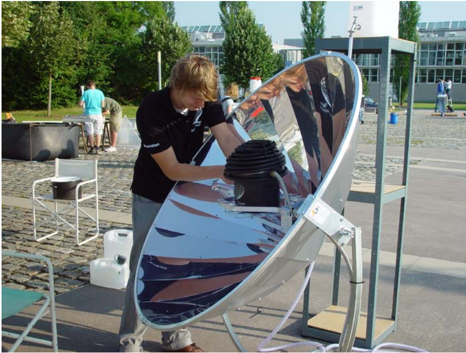
Maximilian Strauß mit seiner Anlage „Solarkocher“ – konventioneller Solarkocher mit Kochtopf und innovativem, zum Patent angemeldeten Deckel
