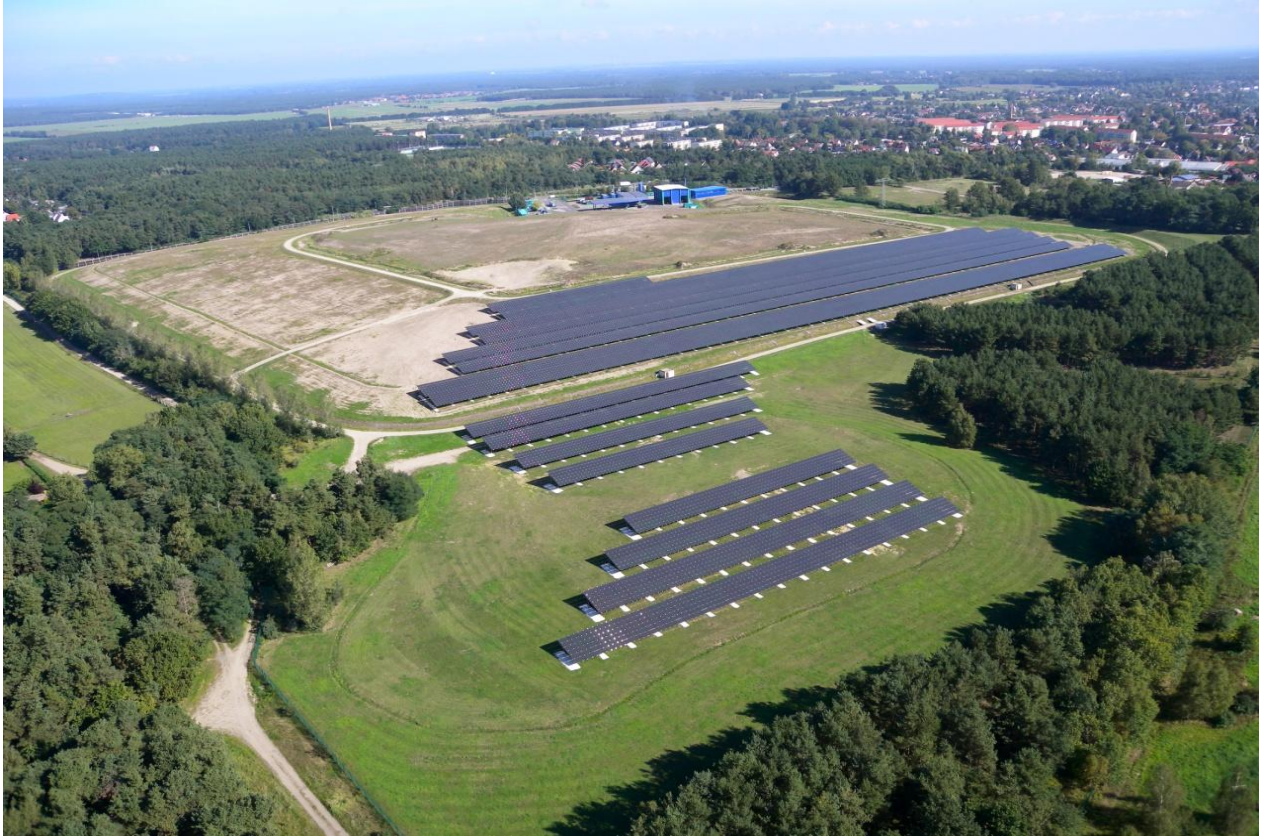
Solkraftwerk von Nanosolar für 1.7MW, auf einer Müllhalde bei Luckenwalde
