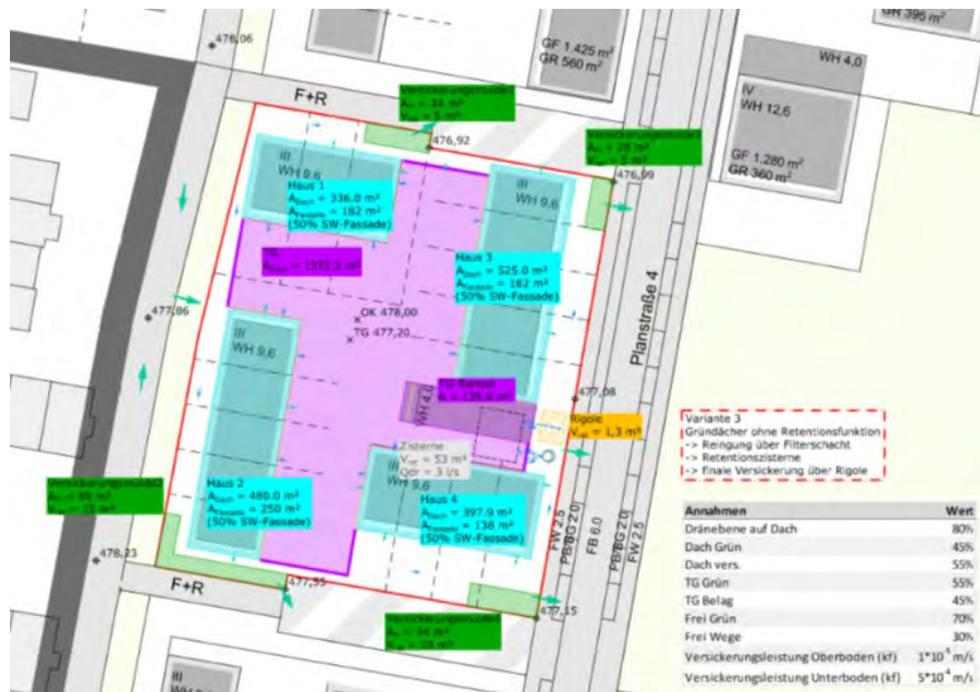
Für die beispielhaften Quartiere gilt, dass neben den dargestellten Varianten auch andere Möglichkeiten, wie z.B. über Filter- und Versickerungsmulden, durch Retention auf den Dächern der Gebäude und der Tiefgarage in Kombination mit technischen Einrichtungen wie Zisternen oder Rigolen, untersucht wurden und möglich sind.
